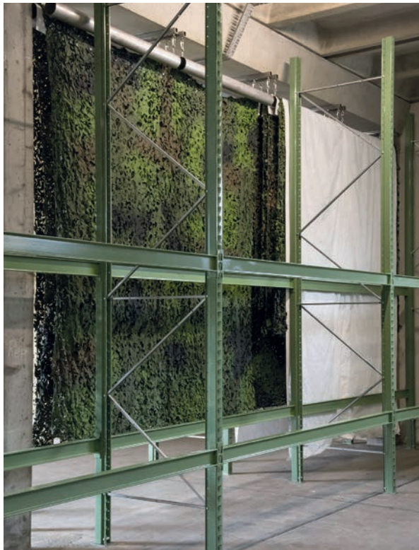
Kontaktlos aufgehängte PVC-Tarnnetze
