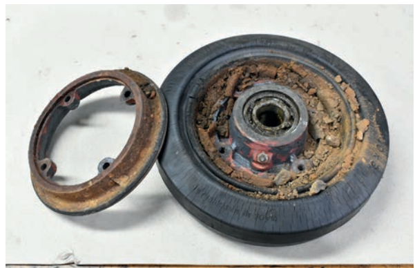
Rost in der Felge des Stützrads
