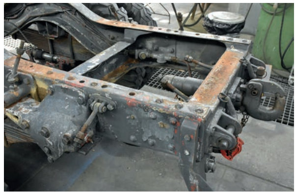
Farbschäden und Rost des Chassis
